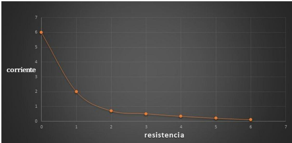
En esta figura se representa el eje vertical como la corriente y la horizontal como la resistencia. La línea naranja nos muestra que cuando no hay resistencia la corriente tiende a llegar a infinito, pero cuando ya se le va agregando más resistencia hay una disminución de corriente que tiende a llegar muy cerca de cero.
