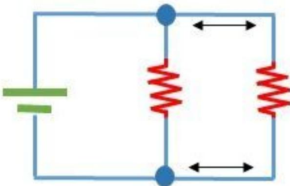
La conexión en paralelo se da cuando dos resistencias unen sus patas entre si abriendo más caminos para que la corriente llegue a tierra.
