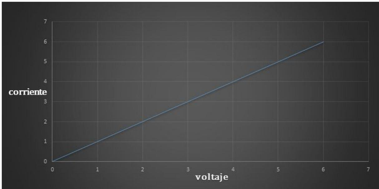
En esta figura representamos el eje vertical como la corriente y la horizontal es el voltaje. La línea azul explica como la corriente aumenta en cuanto se le va agregando más voltaje y caso contrario es que va disminuyendo.
