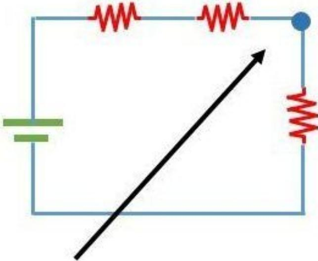
La conexión en serie se da cuando juntamos una pata de la resistencia con otra, sin que haya algo que obstruya el flujo de corriente entre estas. Su principal característica es que solo sigue un camino en la conducción de electricidad.
